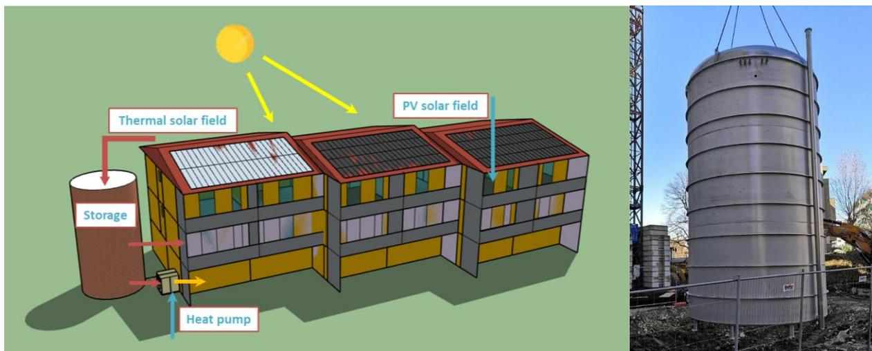
Figura 32\_Schema di impianto per la copertura completa di fabbisogno energetico elettrico e termico di una micro-rete di utenze. Lo storage termico fotografato a destra è relativo all'intervento presso via di Torre degli Agli a Firenze, è interrato ma potrebbe anche essere posto al livello del suolo se curato esteticamente nella parte esteriore. A questo riguardo sono presenti in Italia soluzioni anche accattivanti, messe a punto con la collaborazione tra ingegneri e architetti.
